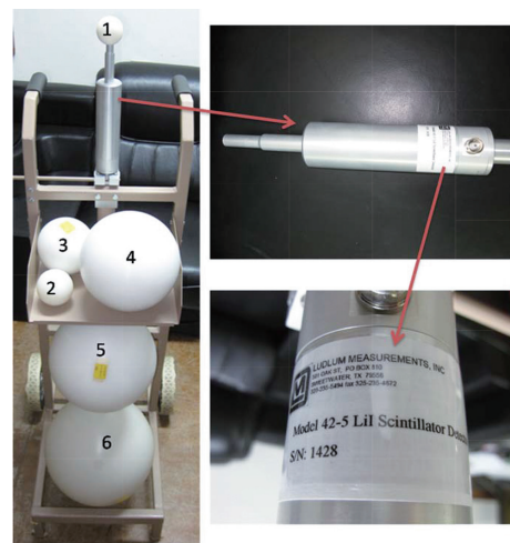
圖 1：左圖為 Ludlum Measurements 公司出產中子能譜偵檢儀，型號：Model 42-5；編號 1-6 的 BSS 的尺寸為 0, 2, 3, 5, 8, 10 及 12 英吋。
