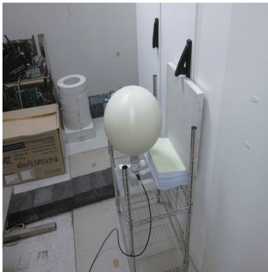
圖 6：在迴旋加速器自我屏蔽外，使用 Bonner sphere spectrometer 搭載 {}^6\text{LiI}(\text{Eu}) 方法，將偵檢器放置於加速器左側靶極端，距離加速器表面 30 公分處，高度在 100 公分位置，評估 1 號靶在增加不同厚度 PE 板與 \text{BaSO}_4 板的屏蔽下其中子量的變化。
