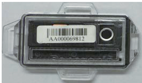
圖 4：OSLD 光子人員劑量計佩章為 InLight OSLD 卡片，所使用的晶片材料為 \text{Al}_2\text{O}_3:\text{C} ，佩章盒是用 Panasonic UD-874A Holder。
