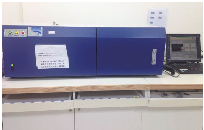
圖 3：OSLD 與 OSLND 之計讀儀為 Landauer 公司出產，型號 Inlight system #40 Automatic Reade，每片計讀的時間大約 30s，不需要氮氣氣體供應。
