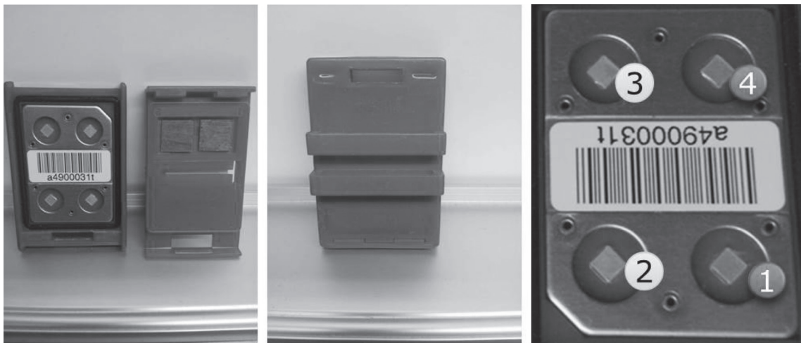
圖 1：測量光子劑量熱發光劑量計佩章的配置與設計，晶片組是使用 Harshaw 6776 TLD 卡片，佩章盒是使用 Harshaw 8806 佩章盒。
