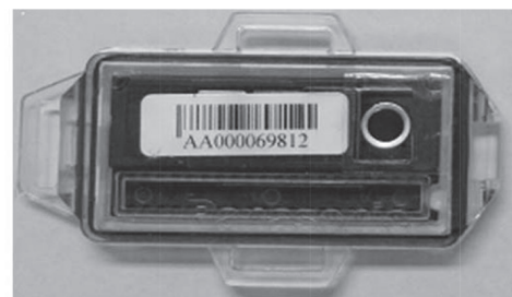
圖 3：OSLND 中子人員劑量計佩章受到中子輻射照射時， ^6\text{Li} 會與中子作用後而同時放出 Tritium ( ^3\text{H} ) 與 Alpha ( ^4\text{He} ) 粒子，然後 \text{Al}_2\text{O}_3:\text{C} 會將 ^3\text{H} 與 ^4\text{He} 粒子的產生量記錄下來。
