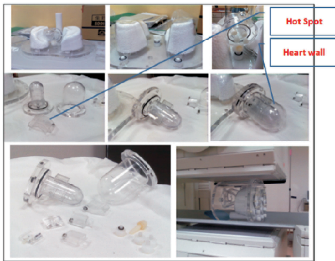
圖三：本次使用之 Torso Phantom 以及各個部份。
