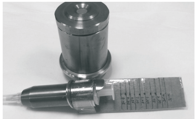
圖一：「屏蔽組」所用之鎢鋼製屏蔽裝置：無菌瓶護套（上方）與針筒護套（下方）及自製比例尺（配合 Terumo 2.6 mL syringe with 24 G needle）。
